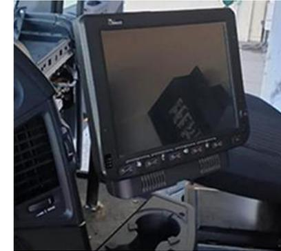
FM10Q VMC sicher im Fahrzeug installiert
