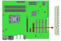
PCIE1: PCI-E X1 Slot
