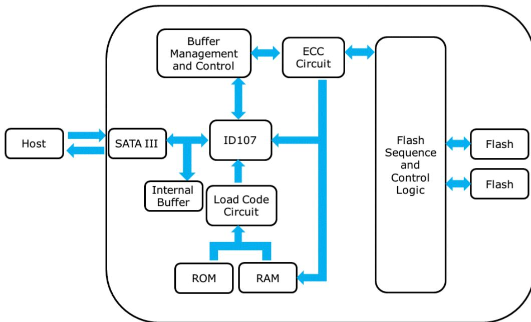
**Figure 2: Innodisk mSATA mini 3IE Block Diagram**
