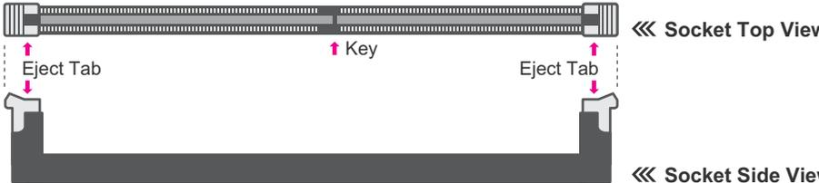
► System Memory ► Installing the DIMM Module
