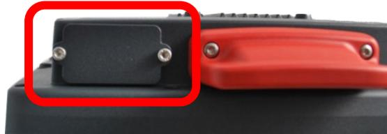
Abbildung 2-1: Akkufach oben am DLT-V72
