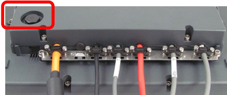
Abbildung 13-6: Druckausgleichselement
