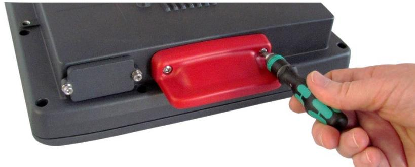
Abbildung 7-5: WLAN-Antenne IEEE 802.11 a/b/g/n/ac öffnen
