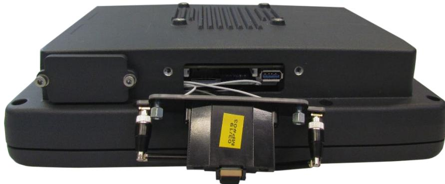
Abbildung 7-10: Antennenmodul WLAN, WWAN LTE 4G
