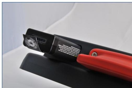
Abbildung 14-2: Akkupack in das Akkufach einsetzen
