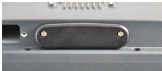
Abbildung 7-3: DLT-V72 mit Blindkappe (ohne Antenne)
