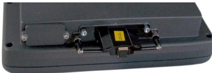
Abbildung 7-9: Geöffnete WLAN, WWAN LTE 4G Antennenkappe
