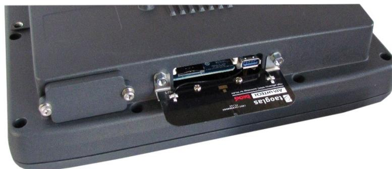
Abbildung 7-6: Geöffnete WLAN-Antenne IEEE 802.11 a/b/g/n/ac
