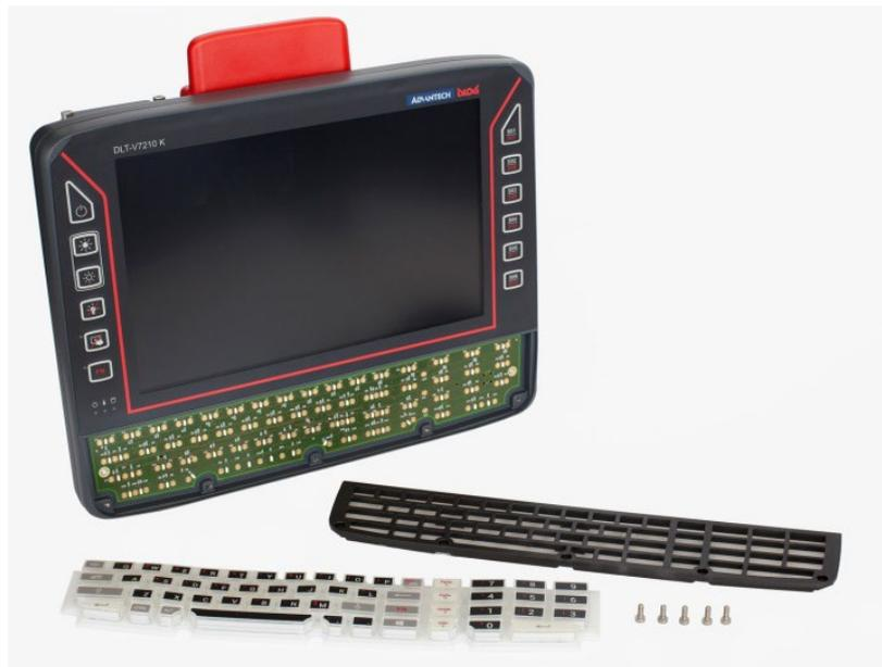
Abbildung 16-2: Integrierte Tastatur - Komponenten
