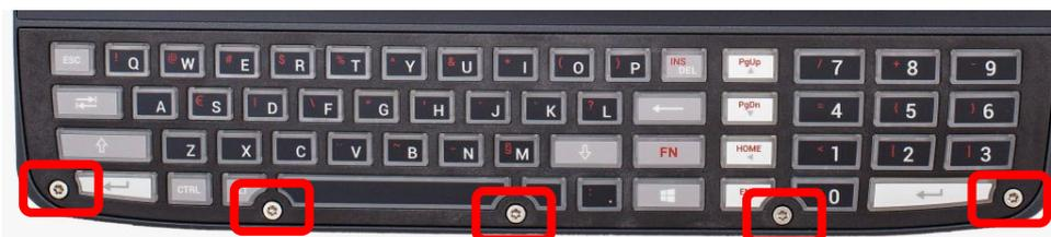
Abbildung 16-1: Integrierte Tastatur - Befestigungsschrauben lösen
