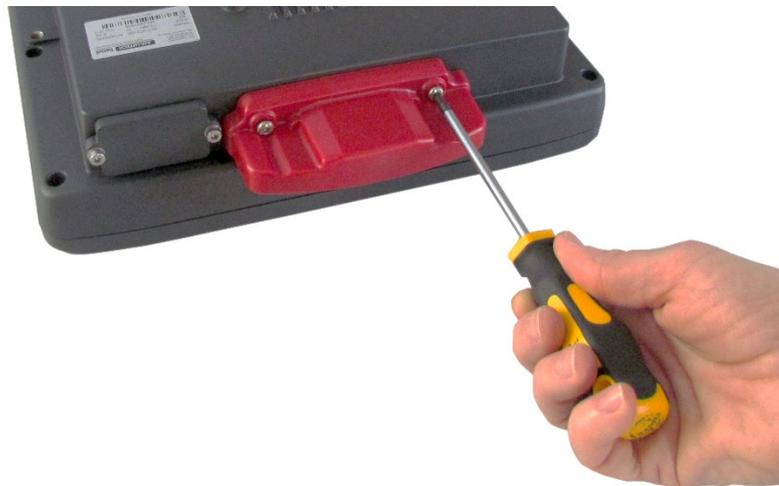
Abbildung 7-8: Antennenkappe der WLAN, WWAN LTE 4G Antenne
