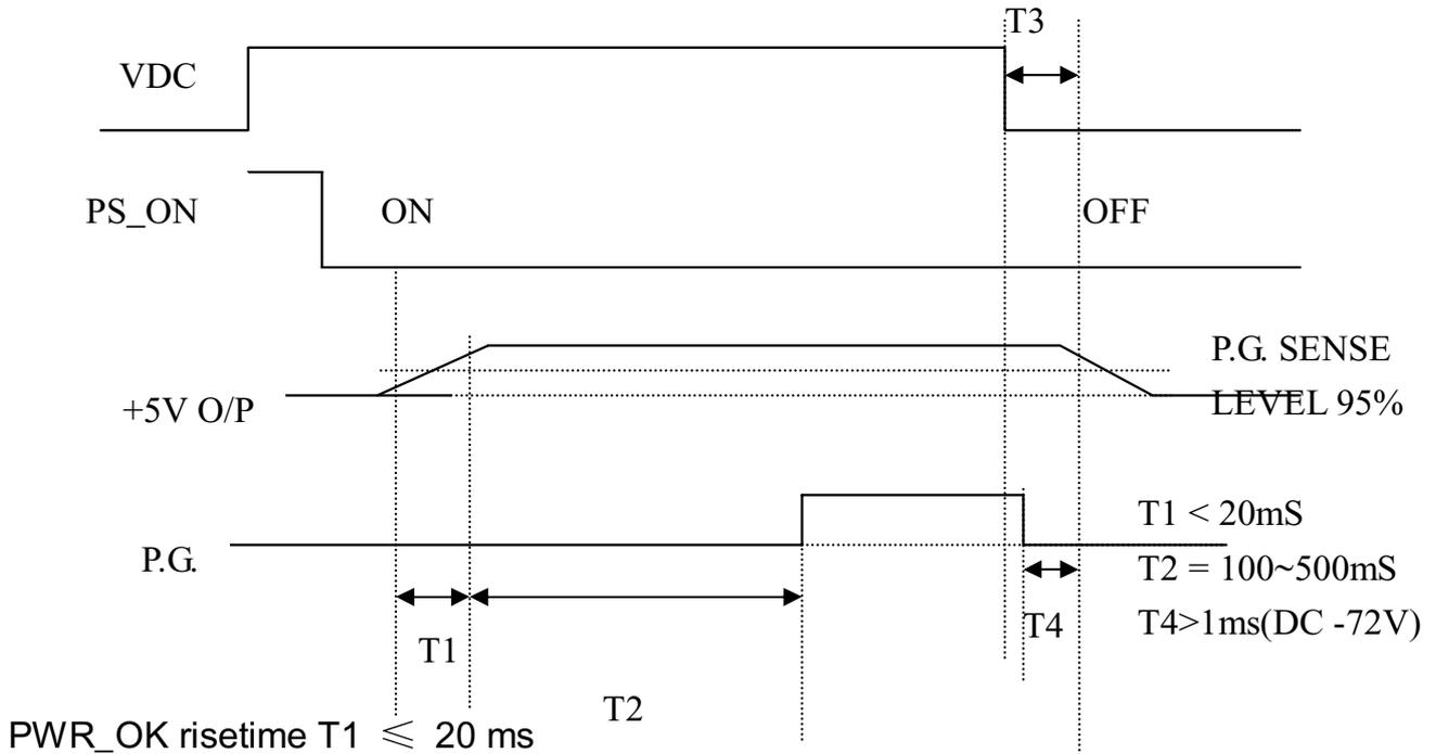
PWR\_OK delay  $100\text{ ms} < T2 < 500\text{ ms}$
